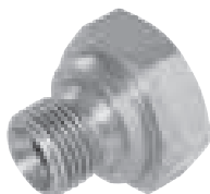
Plug met zeskant kop - BSP male 60° binnenconus DIN 3852 Form A
