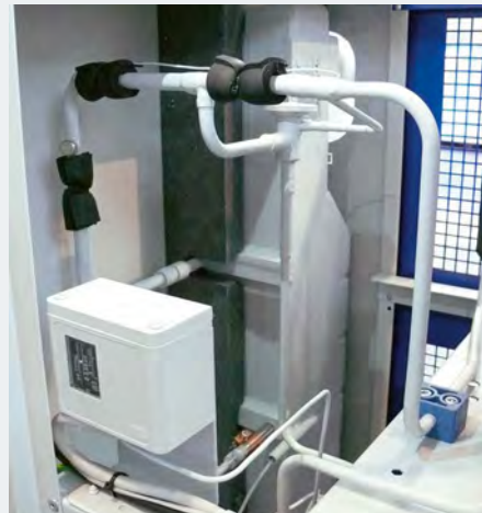
Binnenzijde gecoate koeldroger
